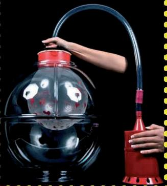
Blasen Sie den Ballon mit Hilfe des Verbindungsschlauches auf, bis sich die Kugelhälften heben.
