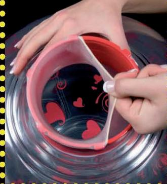
Entnehmen Sie den Schutzmantel und lösen Sie den Ballon vorsichtig von der Maschine.
